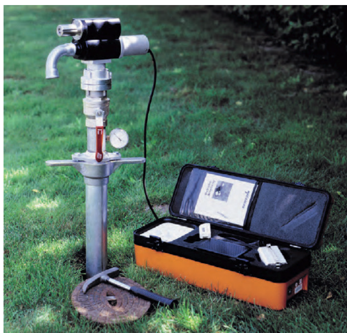
ИСПОЛЬЗОВАНИЕ СТОППЕРА на ПОЖАРНОМ СТЕНДЕРЕ
